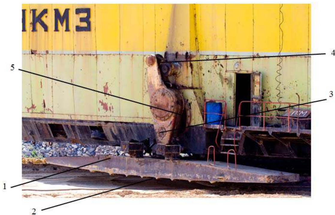
Рис. 1. Кривошипно-рычажный механизм передвижения шагающего экскаватора
